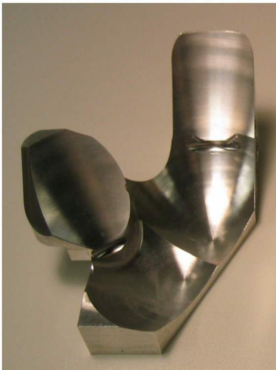
4 spiegels uit 1 blok aluminium
